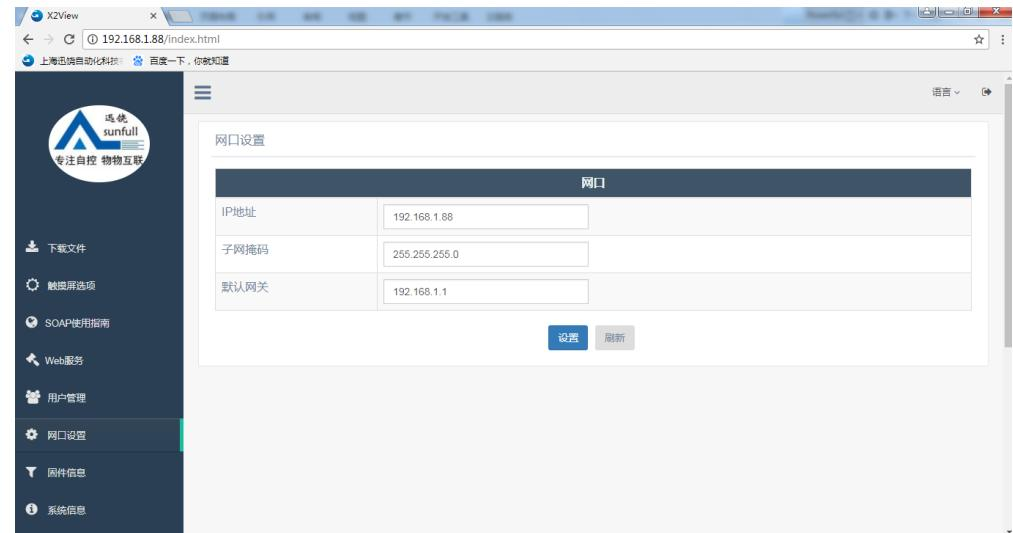
注：进入 web 服务器后下载网关配置软件，具体操作请参考 Help 文件夹下的 PDF 文档。
